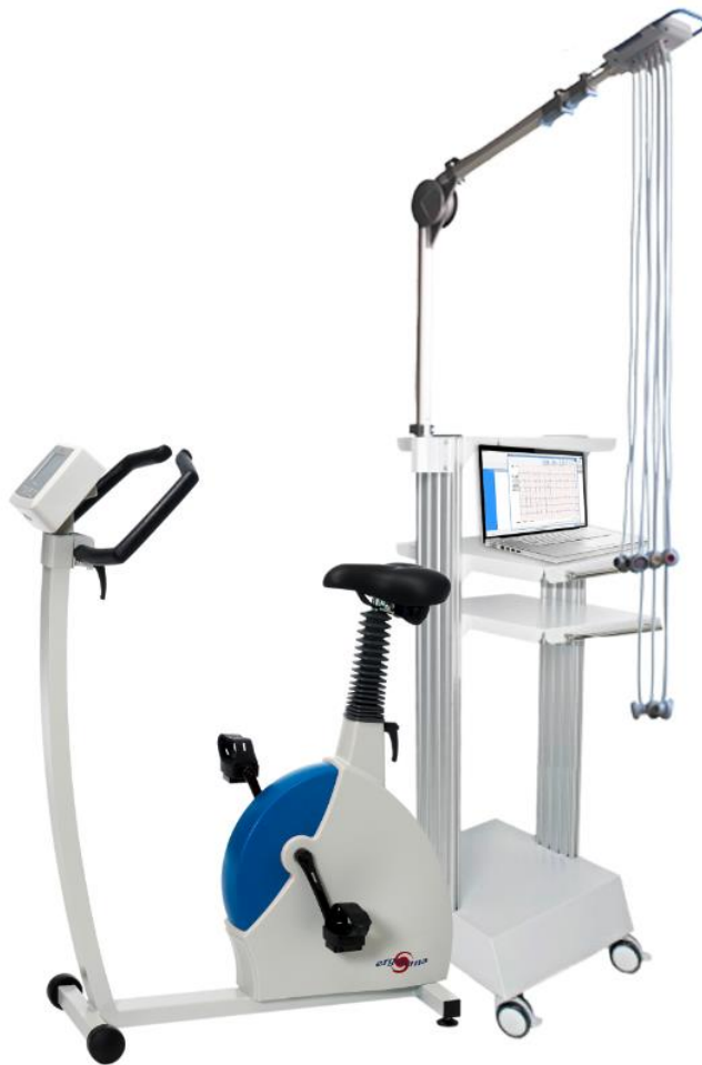
Abb. CARDIAX EKG-Messplatz mit Belastungs-EKG (inkl. Gerätewagen, PC-Notebook, Elektroden-Sauganlage und Fahrradergometer)
