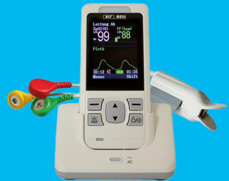
MS 800 Handheld-Pulsoximeter mit integrierter Pulswelle, programmierbaren Alarmtönen und 3-Kanal-Notfall-EKG, Akkubetrieb, Ladestation
