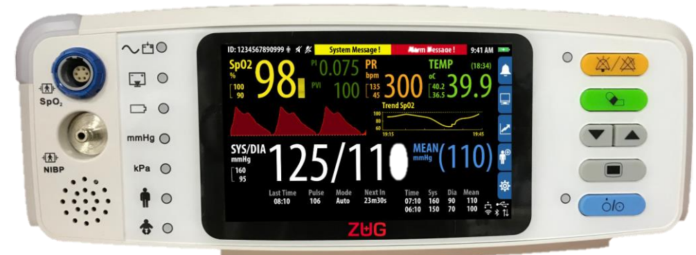
MS 1100 Typ SpotLife® Vitalparameter-Monitor Mit Anzeige von SpO2, Pulsrate, Perfusionsindex, Pulswelle und noninvasivem Blutdruck.
